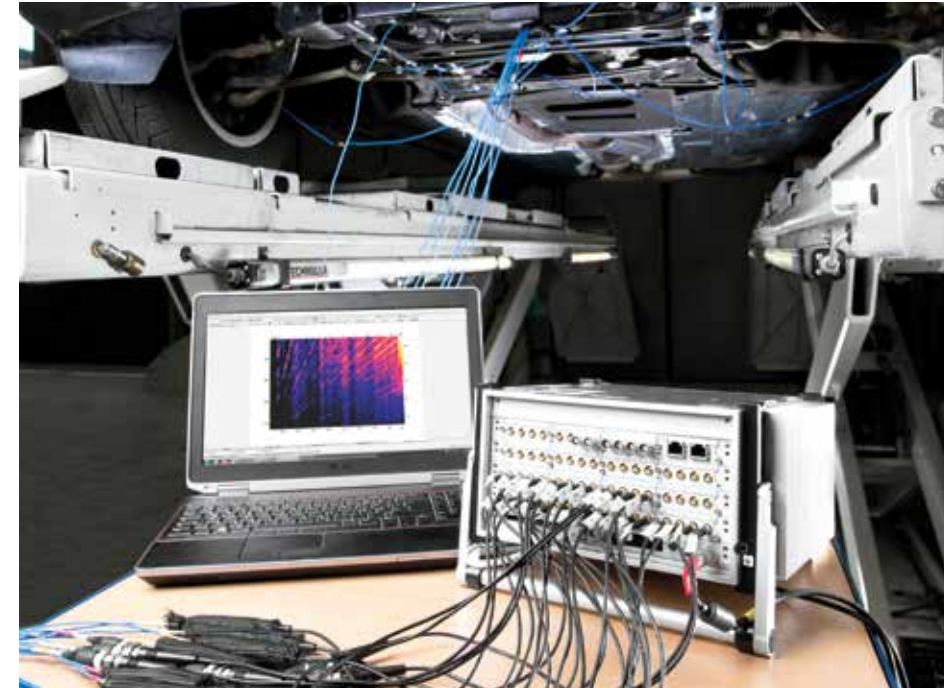
Ein Analysator misst über Sensoren, wie einzelne Bauteile beim Fahren mitschwingen und zum Fahrgeräusch beitragen – zum Beispiel an der Vorderachse des Wagens.
