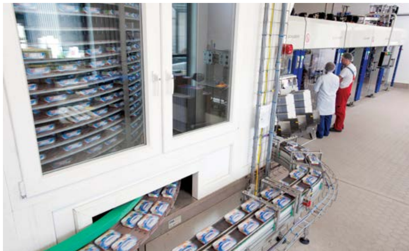
Fertige Frischkäse-Verpackungen nach ihrer Rückkühlung auf dem Weg zur Endverpackungsmaschine (im Hintergrund)
