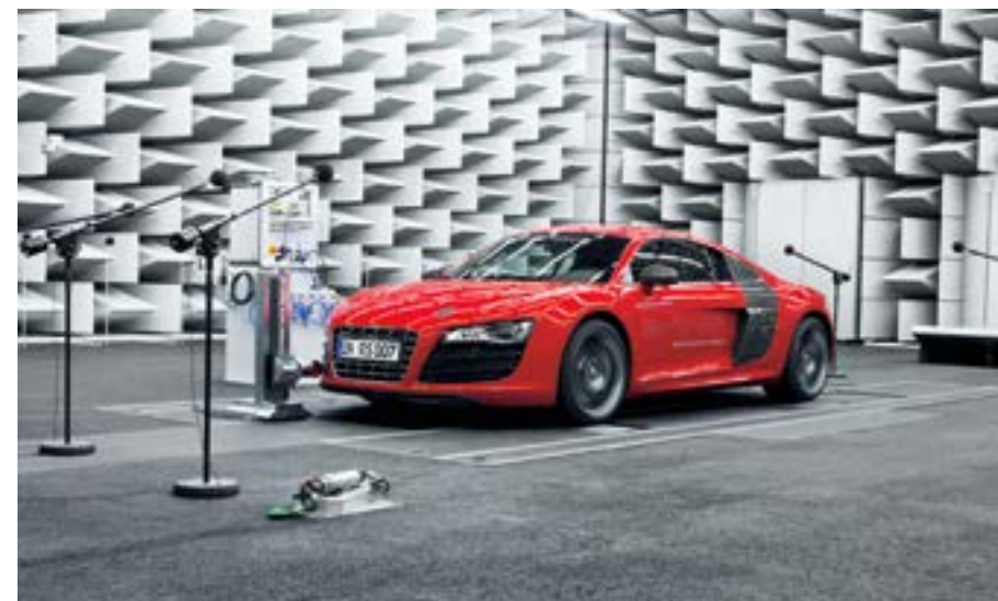
Achtung, Aufnahme: Ein Audi R8 e-tron am Akustik-Prüfstand.
