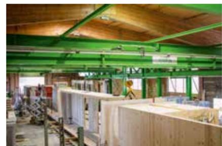
In der Feldfabrik werden die fertigen Elemente zusammengebaut und komplettiert.
