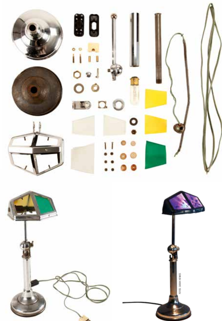
Die kaputte Art-déco-Lampe wird zerlegt, ein Bauplan entworfen und irreparable Teile am 3D-Drucker nachgefertigt.
