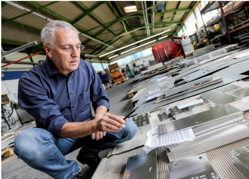
Wolfgang Ermert, kaufmännischer Leiter bei AMS, führt das neue System vor: Über das Smartphone kann er den Ablageort von Bauteilen registrieren – und so das spätere Auffinden erleichtern.
